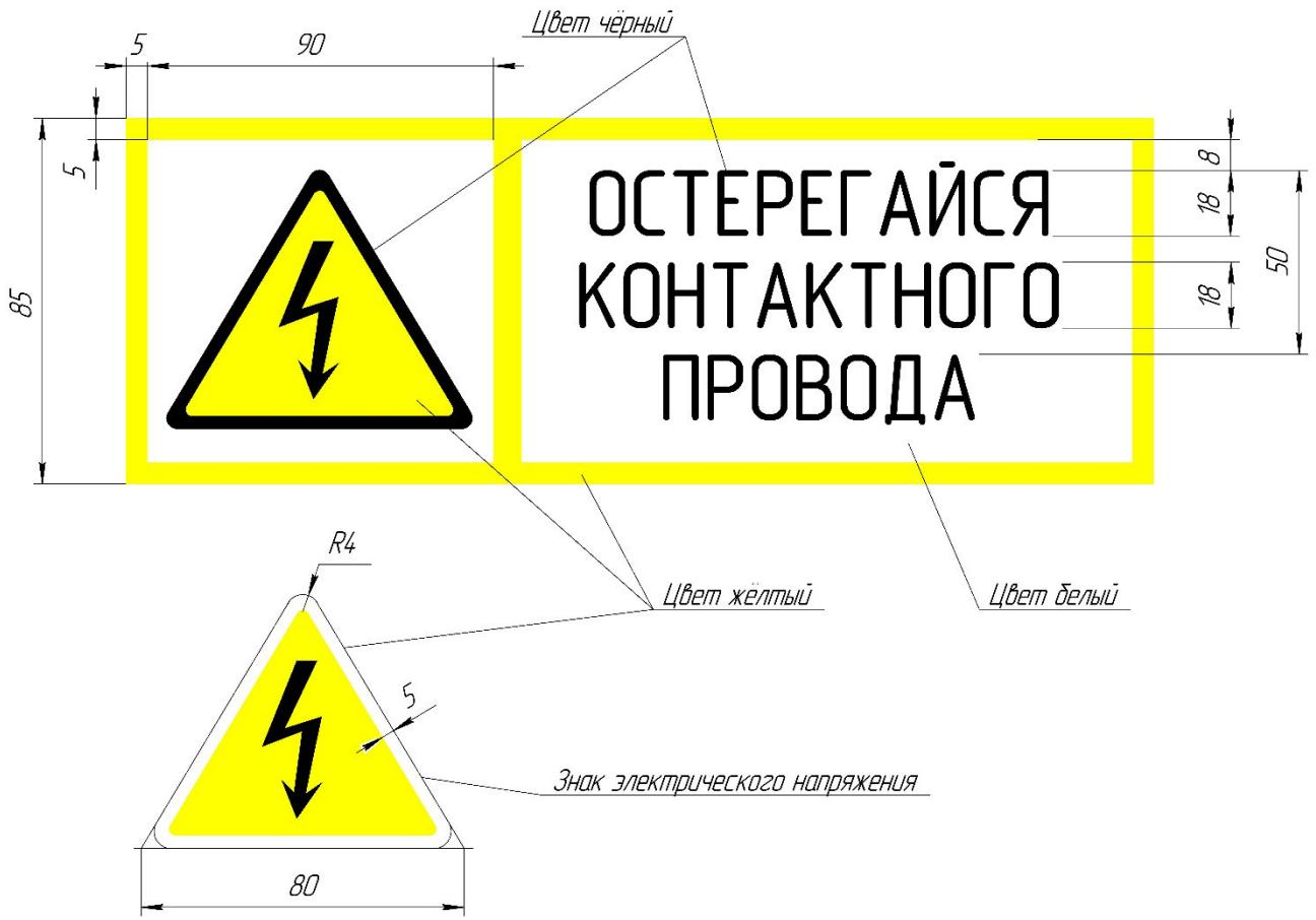
Рис.2. Знак наносится на вагоны железных дорог колеи 1520 мм.
