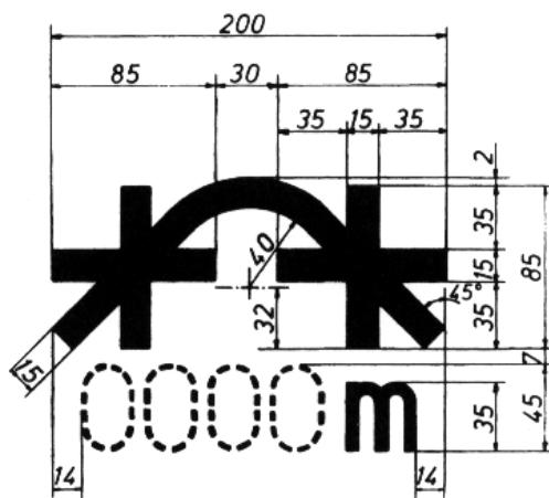
Рис. 2 Расспуск разрешен только с сортировочных горок, радиус кривой (закругления) которых больше указанного на знаке
