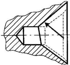
Схема повреждения центрального отверстия
