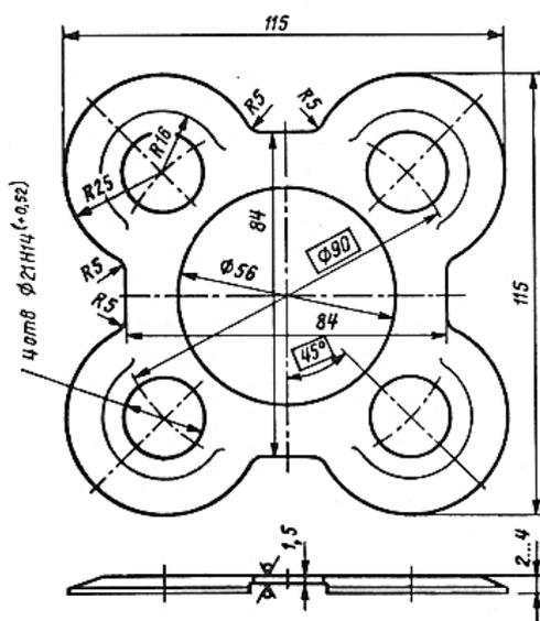
Для стопорения четырех болтов M20
