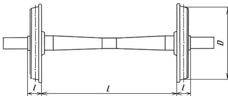
Рисунок 8.1- Колесные пары типа РУ1Ш-957-Г или РВ2Ш-957-Г
