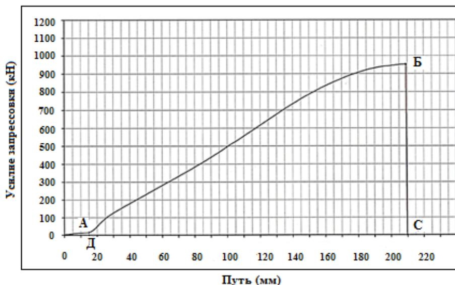
Рисунок 17.2 - Нормальная диаграмма запрессовки при записи на компьютере
