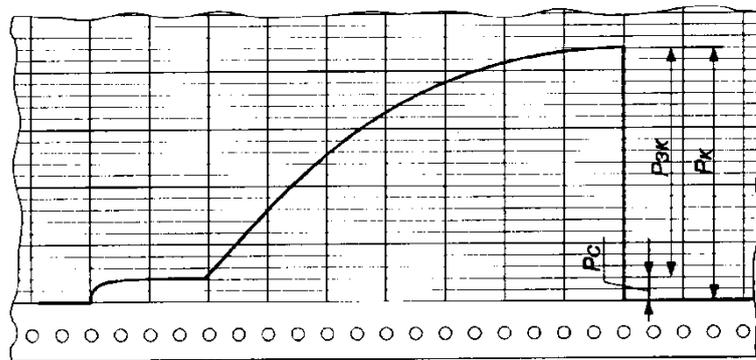
Рисунок 29.4 Диаграмма с записью холостого хода плунжера пресса
