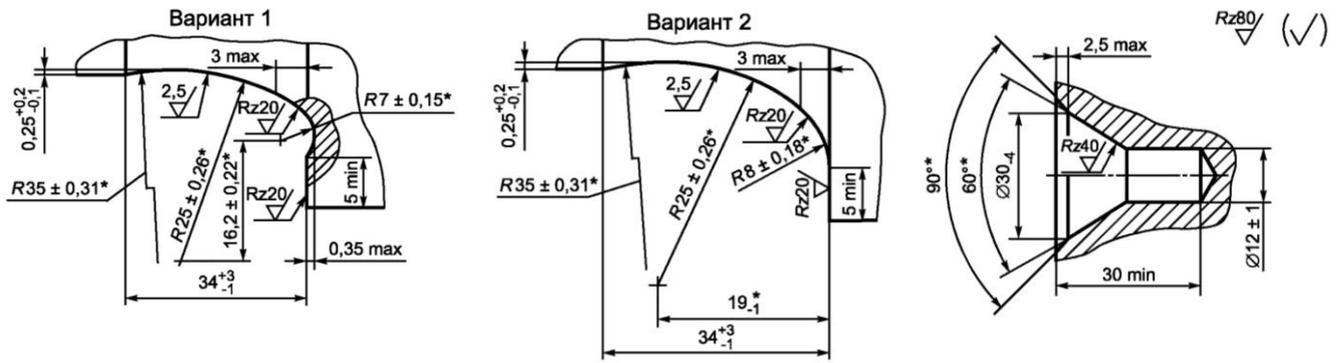
\*Размеры обеспечиваются инструментом
