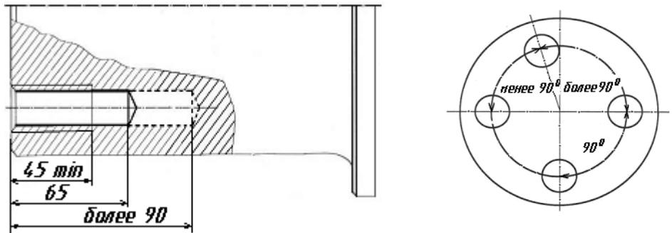
Измерение глубины отверстий и их смещения.
