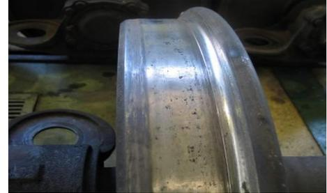
Визуальный контроль и замеры. Измерение глубины («А» или «Б») и ширины («В») производят с помощью глубиномера и линейки.
