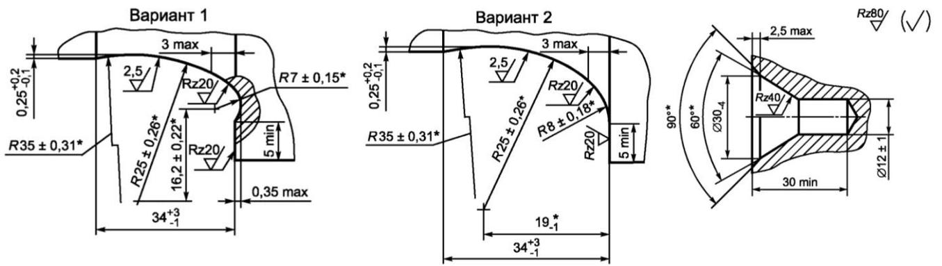
\* Размеры обеспечиваются инструментом
