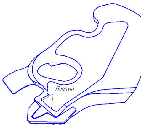
Рисунок 2.27 - Проверка направляющего зуба замка шаблоном 943р
