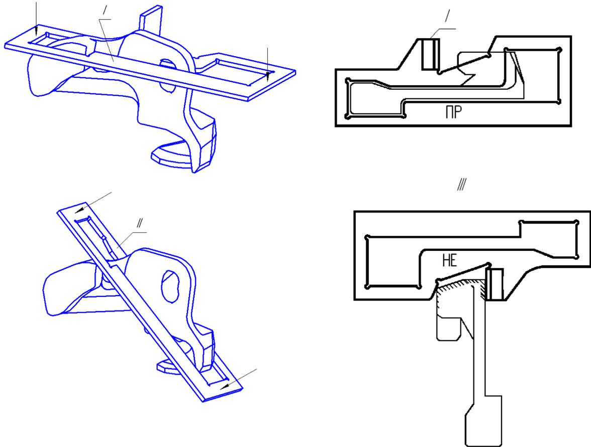
Рисунок 2.29 - Проверка толщины замкодержателя автосцепки и ширины его лапы шаблоном 841р
