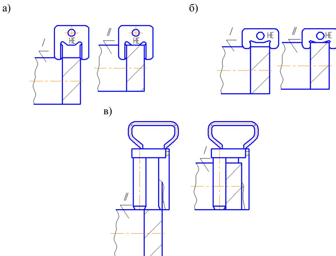
Рисунок 2.18 - Проверка толщины перемычки хвостовика автосцепки СА-3: а-непроходным шаблоном 897р-1 или 898р-1; б- непроходным шаблоном 900р-1; в- проходным шаблоном 46г (*I* – перемычка годна; *II* - перемычка негодна)
