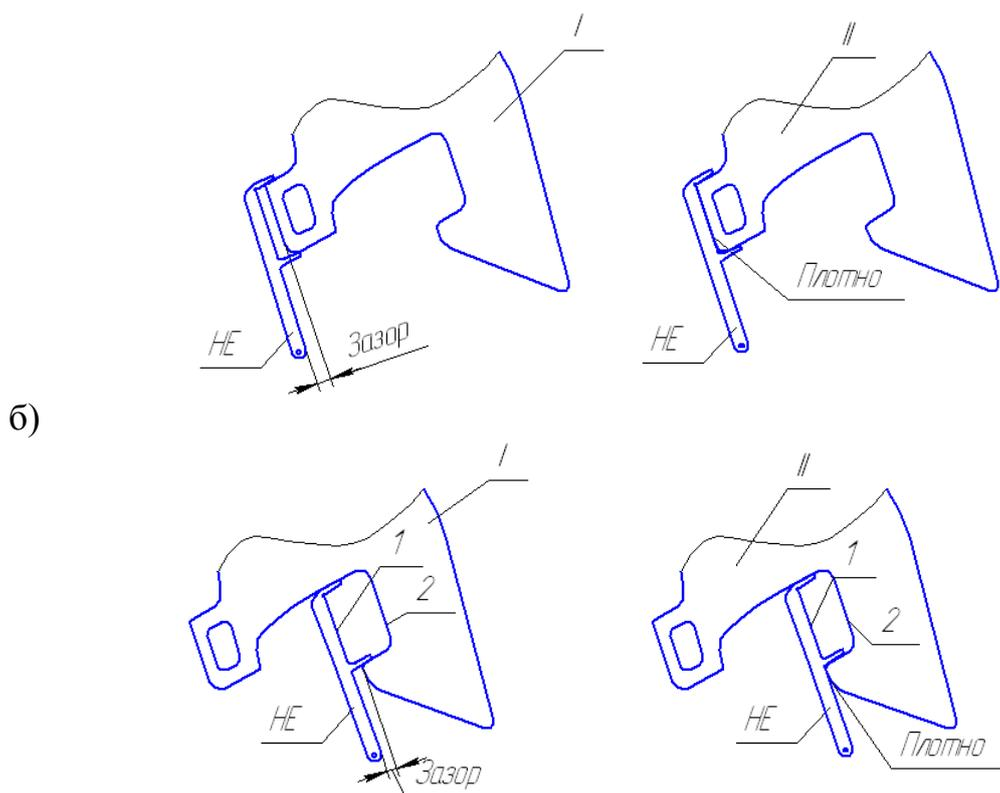
Рисунок 2.2 - Проверка шаблонами 892р, 893р, 884р: а-длины малого зуба; б-расстояния между ударной стенкой зева и тяговой поверхностью большого зуба; I-корпус годен; II- корпус негоден (внутренняя грань I шаблона должна быть параллельна боковой поверхности 2 большого зуба)
