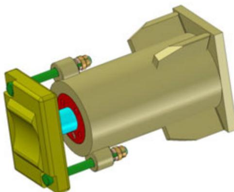
Рисунок 2.56 - Поглощающий аппарат АПЭ-120-И
