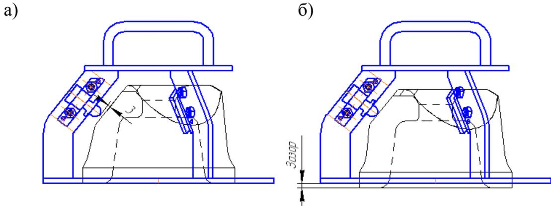
Рисунок 2.46 - Проверка нажимного конуса поглощающего аппарата шаблоном 611(611-1). Конус негоден, если между концом движка и плоскостью конуса имеется зазор более 3 мм (а), зазор между кольцом шаблона и плитой (б)
