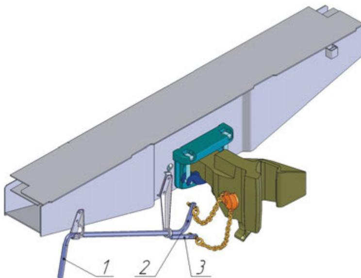
Рисунок 2.75 – Расцепной привод автосцепки
