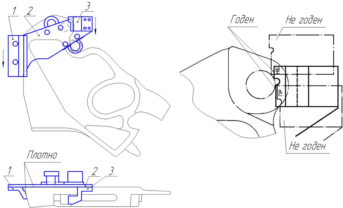
Рисунок 2.24 - Проверка положения шипа замка шаблоном 833р
