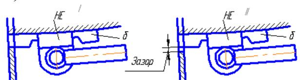
Рисунок 2.4 - Проверка ударных поверхностей зева и малого зуба авто-сцепки профильной планкой 914р/24-1м шаблона 914р-м
