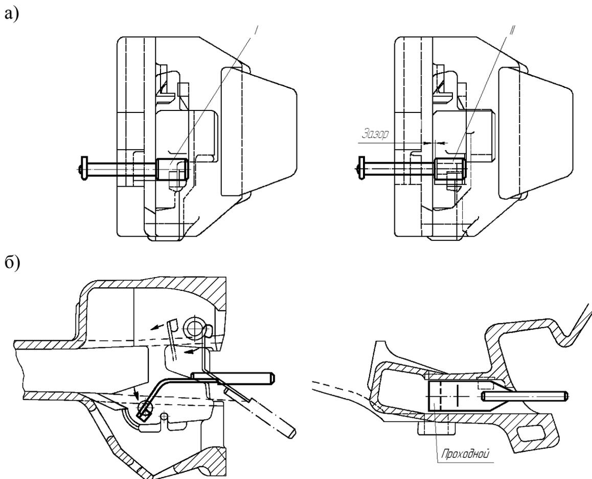
Рисунок 2.9 - Проверка ширины кармана корпуса автосцепки:
