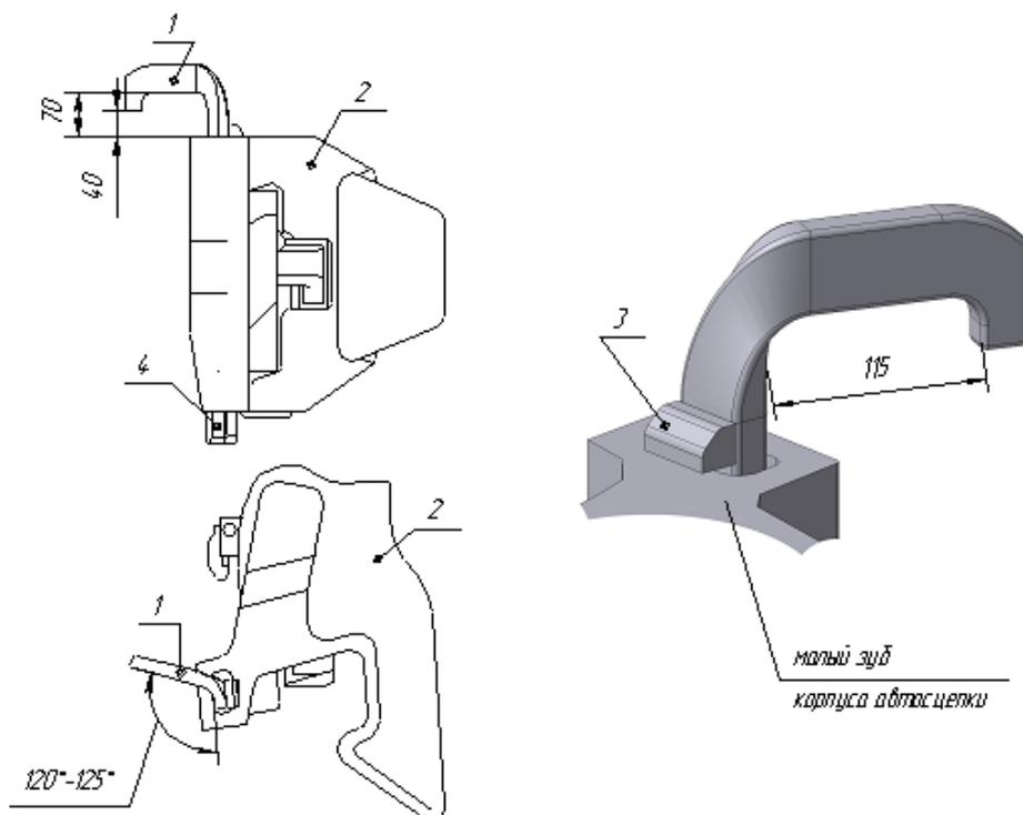
Рисунок 2.43 - Паровозная автосцепка с предохранительным крюком
