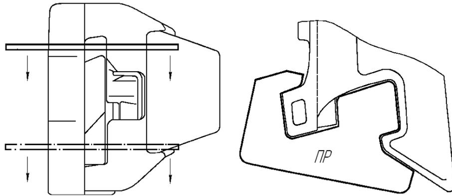
Рисунок 2.35 - Проверка контура зацепления собранной автосцепки шаблоном 828р
