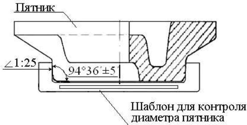
Рисунок 5 Измерение износа опорной и упорной поверхностей пятника
